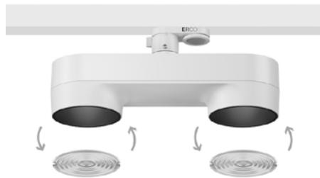
Su estructura modular convierte a los downlights para raíles electrificados Iku en una herramienta de iluminación sumamente adaptable: las tres distribuciones luminosas disponibles, wide flood (70°), extra wide flood (80°) y oval flood (20°x60°) se definen por sus lentes intercambiables.
