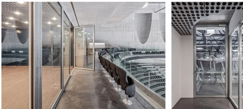
À l'intérieur, des portes et vitrages fixes des systèmes forster unico, en partie en version coupe-feu EI30, ont été utilisés. Comme souhaité par les architectes, tous les éléments de finition de Forster Profilés sont réalisés avec une surface «galvanisée à chaud». Photographie: © R&D Dürr
