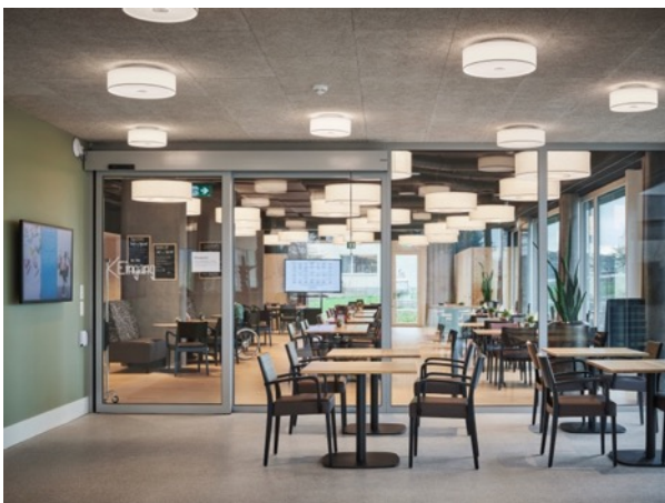
Das Restaurant im Erdgeschoss ist durch die automatische Brandschutzschiebetür mit forster fuego light EI30 sicher und barrierefrei erschlossen. Fotos: © Damian Poffet
