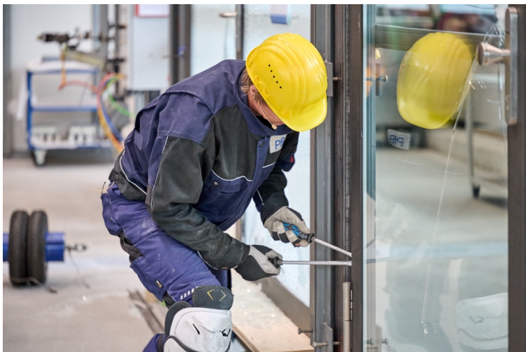
Live-Demonstration der Sicherheitsstandards: Mehrere Einbruchtests über den Tag verteilt zeigten die Stabilität und Widerstandsfähigkeit der Forster-Profilsysteme aus robustem Stahl. Foto: © Thomas Hary
