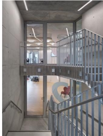
Les portes coupe-feu à un et deux vantaux avec forster fuego light EI30 et EI60 offrent une protection fiable dans la cage d'escalier et s'intègrent harmonieusement dans le concept d'aménagement. Photos : Damian Poffet
