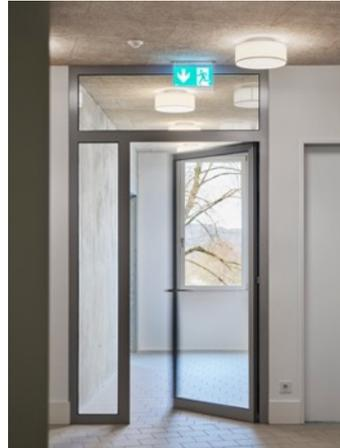
*Des espaces de séjour lumineux avec des vitrages généreux et des portes coupe-feu à deux vantaux EI30 et EI60 du système forster fuego light permettent un mariage harmonieux entre sécurité et transparence. Photos : © Damian Poffet*
