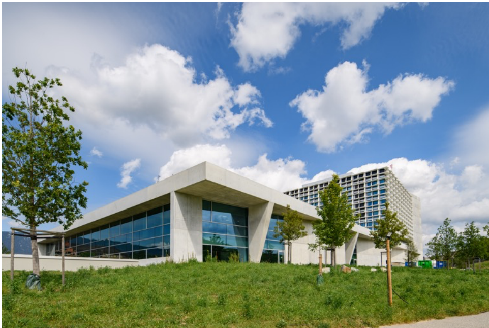
Bei der Verglasung des Sockelbauwerks war ein besonders effizienter Hitzeschutz wichtig, der mit einem Dreifachisolierglas von Glas Trösch erreicht wird. Foto: Glas Trösch
